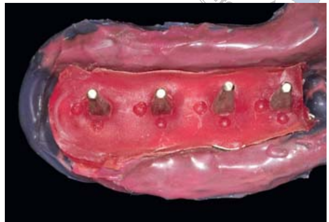
Abb. 3 Palavit G Sockel mit Dowel Pins an den versilberten Zähnen.
